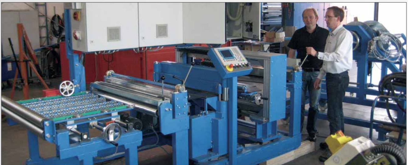
Schneidanlage zur Herstellung von Aluminium-Dachprofilen
